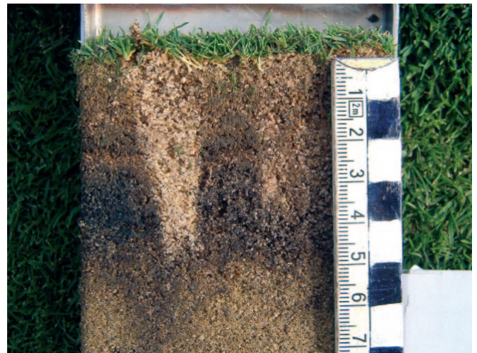
Was die Golfer nicht sehen: Bodenausschnitt eines Grüns mit sandverfülltem Aerifizierloch
